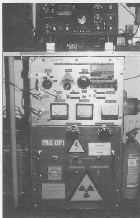
De 800/400 Watt eindtrap voor 40, 20, 15 en 10 meter.
